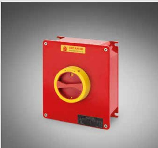
La serie ISOLATORS Fire Rated mantiene la continuità di servizio di un circuito mentre è esposto ad una elevata temperatura ambiente di 400 ° C per un periodo di 120 minuti in conformità con lo standard EN 12101-3 (2015): "Sistemi per il controllo di fumo e calore. Specifiche per gli evacuatori forzati di fumo e calore".
