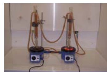
Fig. 2 Bagno di prova secondo UNI EN 579
